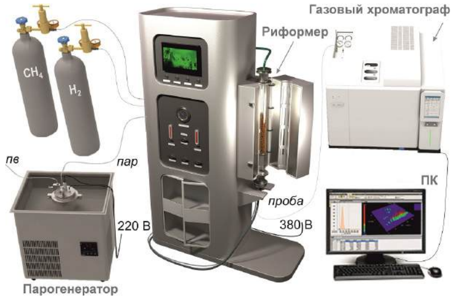
Рис. 8 — Экспериментальная установка для исследования паровой конверсии метана.
